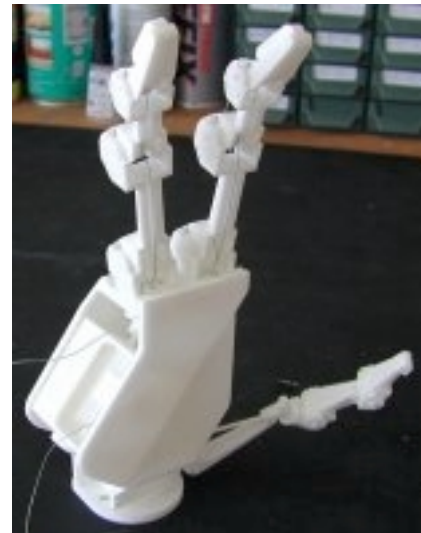
Figura 12: Prototipo in ABS della protesi di mano
